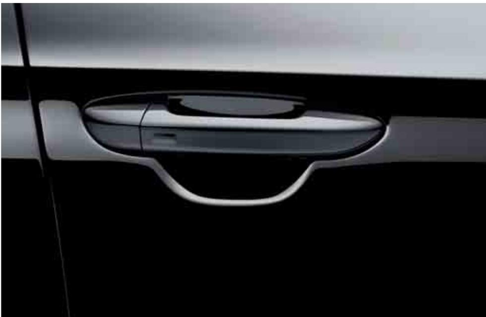
**Keyless:** il sistema di chiusura ed apertura senza chiavi. Non appena si tocca la maniglia della portiera, il sistema sblocca autonomamente le portiere della vettura. Inoltre, nel momento della chiusura viene verificato se hai il trasmettitore con te, in modo da non chiudere le porte quando il trasmettitore si trova ancora all'interno della vettura.
