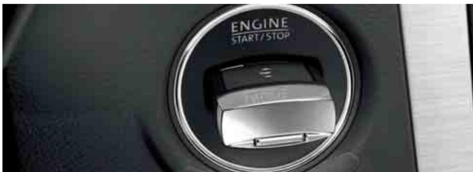
La chiave di accensione elettronica. La chiave a radiofrequenze viene semplicemente inserita e, dopo una leggera pressione, il motore si avvia, senza dover girare la chiave.
