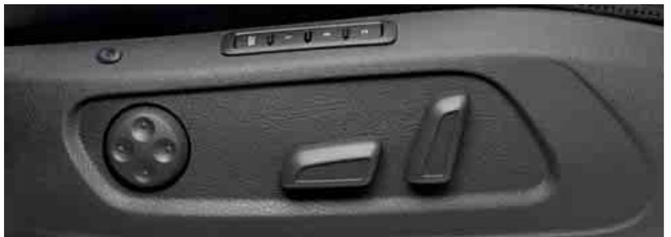
Con i sedili anteriori a 12 regolazioni elettriche potrai personalizzare la tua posizione di seduta. Sia il sedile conducente che quello del passeggero anteriore dispongono di supporto lombare. Per il sedile conducente la funzione Memory può memorizzare fino a tre posizioni di seduta.
