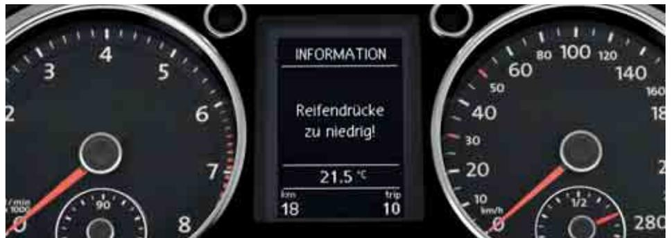
Il **sistema di controllo della pressione degli pneumatici**. Il sistema ti informa, tramite visualizzazione sul computer di bordo Plus oppure Premium (optional) dell'eventuale calo di pressione delle gomme. Il controllo permanente assicura un elevato grado di sicurezza e aiuta, grazie alla corretta pressione degli pneumatici, ad aumentare la durata degli stessi ed a ridurre il consumo di carburante.
