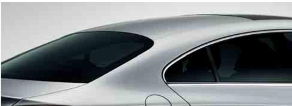
Il **lunotto** e i **finestrini laterali posteriori** oscurati assorbono fino al 65% di luce. Un ulteriore vantaggio: l'oscuramento protegge i passeggeri da sguardi indiscreti.
