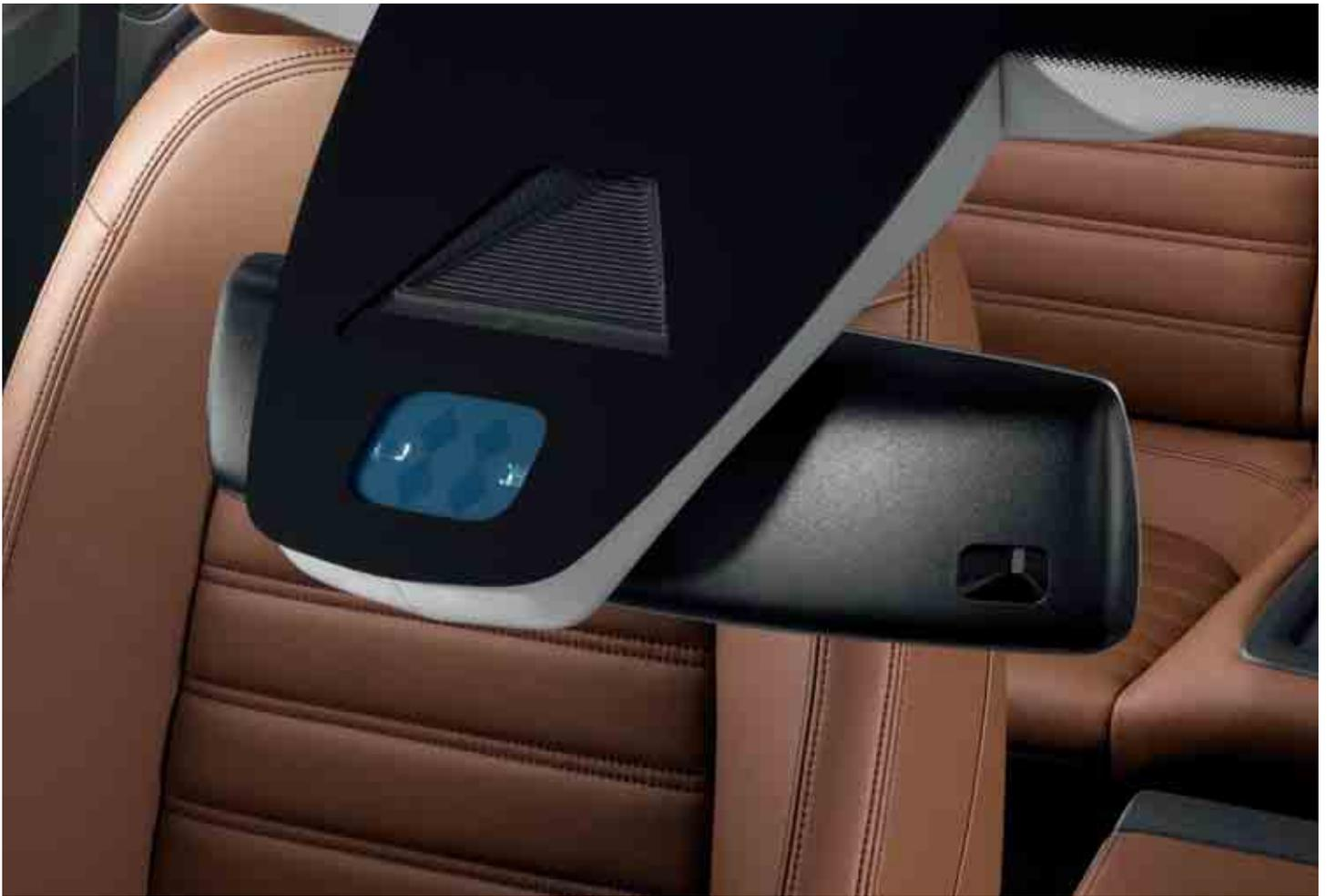
Lo **specchietto retrovisore interno**. Scherma automaticamente le luci riflesse come ad esempio i fari della vettura che ti segue. Il sensore pioggia integrato provvede ad attivare i tergicristalli in caso di maltempo, regolandone l'intervallo, a seconda dell'intensità della pioggia.
