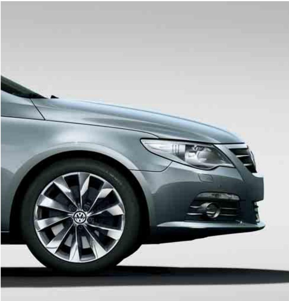
All'insegna della **tutela dei pedoni**. Un esempio d'eccellenza di design intelligente. Per le zone a deformazione progressiva nel paraurti anteriore vengono utilizzati solo materiali particolarmente flessibili. Inoltre è stato abbassato il cofano, aumentando la distanza tra cofano e motore. Tutti questi accorgimenti riducono il rischio di lesioni a cui gli altri utenti del traffico potrebbero venir esposti.
