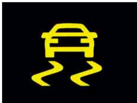
Il **programma di controllo elettronico della stabilità**. Speciali sensori, posizionati sulle ruote, segnalano al sistema la direzione di marcia della vettura; in questo modo il movimento effettivo della vettura potrà essere costantemente allineato alla direzione di guida ideale.
