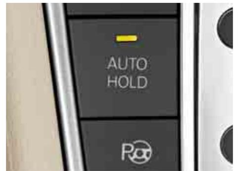
Per evitare che la vettura ferma si muova accidentalmente, la funzione Auto-Hold memorizza l'ultima pressione dei freni. Pertanto, in questo caso, puoi anche togliere il piede dal pedale del freno. Non appena premi l'acceleratore, la pressione del freno si allenta automaticamente.
