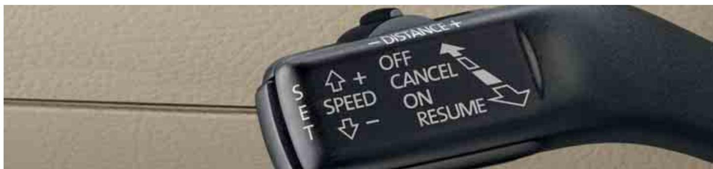
Il Cruise Control in combinazione con il controllo automatico della distanza ACC. A partire da 30 km/h la velocità da te scelta viene mantenuta in modo costante. Non appena azionerai il freno o la frizione, il regolatore di velocità si disinserirà automaticamente. Il controllo automatico della distanza ACC verifica inoltre, tramite radar, la distanza tra te e la vettura che ti precede.
