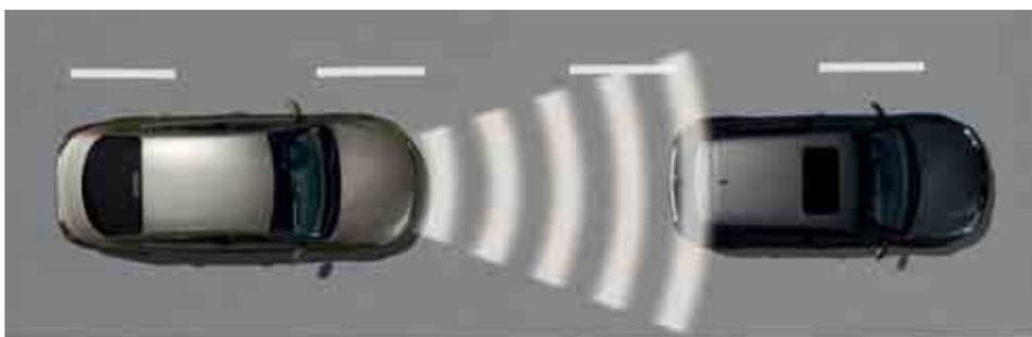
Il controllo automatico della distanza ACC con controllo frontale Front Assist. Il sistema riconosce il rallentamento della vettura che ti precede e riduce automaticamente la tua velocità. Se la distanza tra la tua vettura e chi ti precede si riduce troppo, il sistema frena automaticamente la tua vettura, se necessario fino ad arrestarla completamente.
