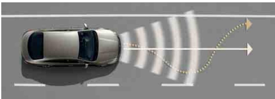
Il sistema di mantenimento della traiettoria Lane Assist ti aiuta a mantenere la traiettoria nella corsia di marcia: tramite una videocamera viene monitorata la segnaletica orizzontale della strada. Ogniqualvolta la vettura dovesse scostarsi involontariamente dalla traiettoria, una leggera controsterzata la riporterà in corsia.
